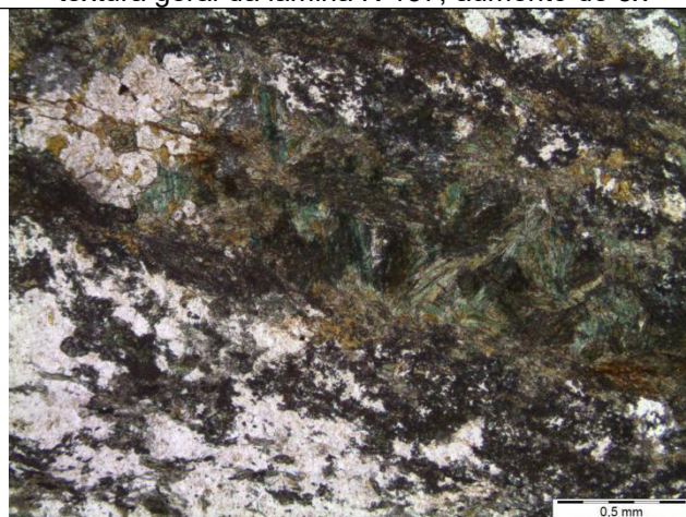
C - Fotomicrografia a polarizadores descruzados, textura de lentes cloritizadas, aumento de 5x
