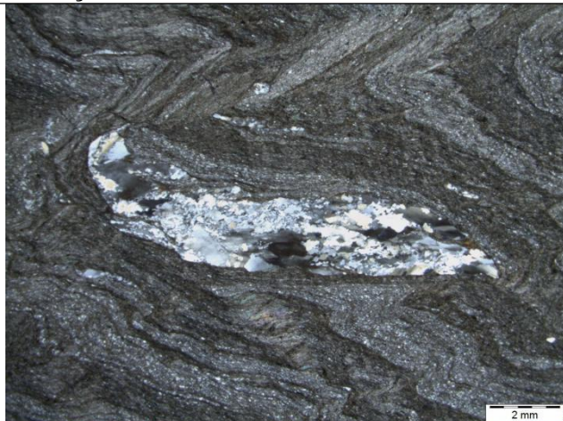
A - Fotomicrografia a polarizadores cruzados da textura de lentes de Qtz K-167(2), aumento de 1x
