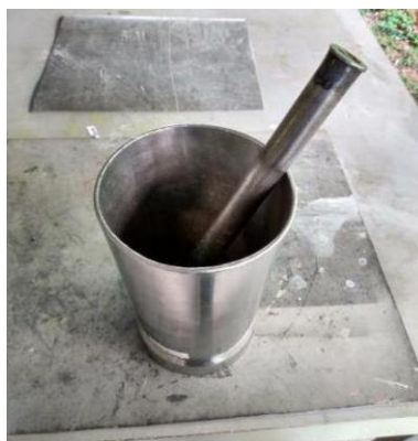
Figura 5: Pilão de aço usado para fragmentar e reduzir a amostra
