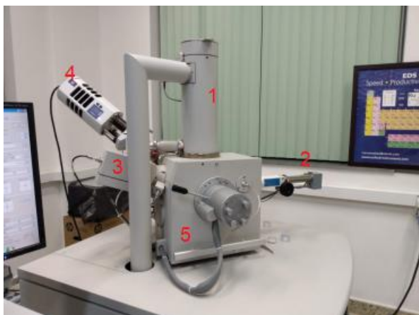
Figura 20: Estrutura do MEV vista de fora. 1 é a coluna de elétrons, 2 o detector de CL, 3 o detector de ES, 4 o detector de EDS, e 5 a câmara de amostra.
