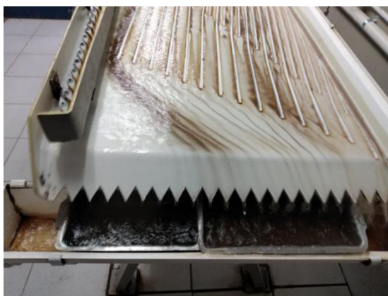
Figura 10: mesa de separação. Material mais denso capturado pelas guias sendo levado pelo fluxo de água para as canecas 1 (à esquerda) e 2 (à direita)
