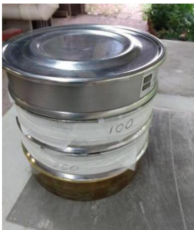
Figura 7: conjunto de peneiras de 60, 100 e 250 mesh do topo para a base.
