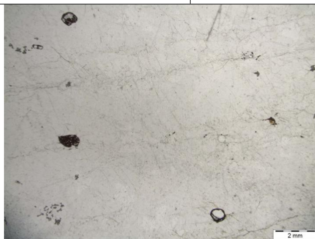
A2 - Fotomicrografia a polarizadores descruzados da textura geral da lâmina K-42, aumento de 1x
