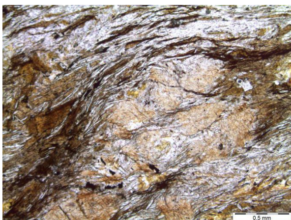
Figura 28: K-152, polarizadores descruzados. Foliação fortemente crenulada marcada por Bt e Ms e porfiroclasto substituído.
