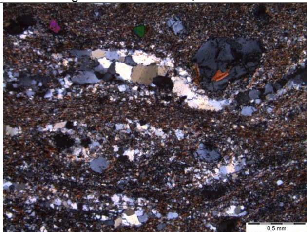
B1 - Fotomicrografia a polarizadores cruzados, textura da foliação milonítica, aumento de 5x
