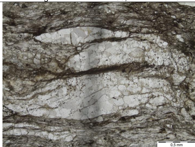
B2 - Fotomicrografia a polarizadores descruzados, textura de lentes de quartzo sigmoidais, aumento de 10x
