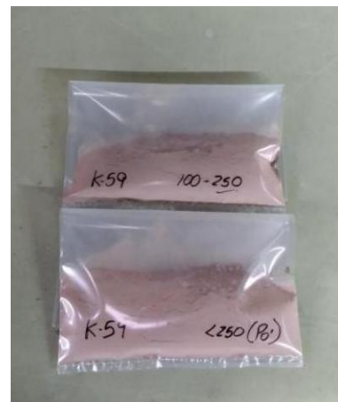
Figura 9: Frações da amostra entre 100-250 e menor que 250 mesh , separadas e identificadas
