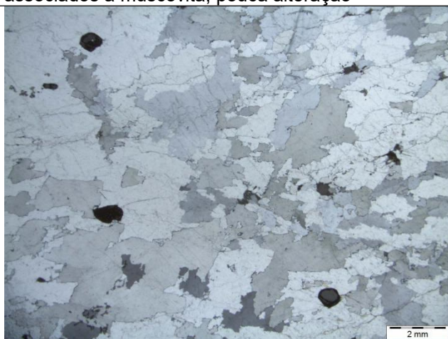
A1 - Fotomicrografia a polarizadores cruzados da textura geral da lâmina K-42, aumento de 1x
