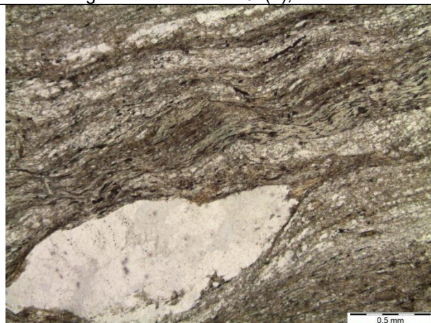
C2 - Fotomicrografia a polarizadores descruzados, textura de lentes crenuladas, aumento de 5x
